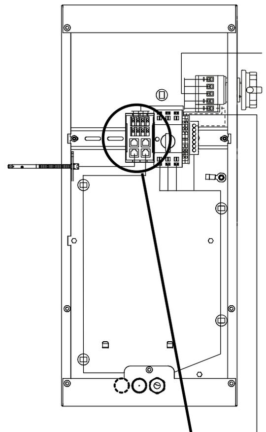
L'adaptateur de câble n'est pas monté. Installez l'adaptateur de câble dans la CTA GOLD sans unité de commande, largement comme sur le schéma de câblage ci-dessus.
