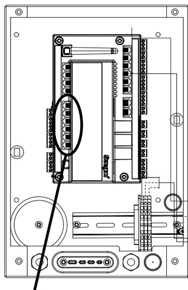
Connecter le câble bus fourni de n'importe quelle borne bus de l'unité de commande vers une borne bus optionnelle de l'adaptateur de câble.
