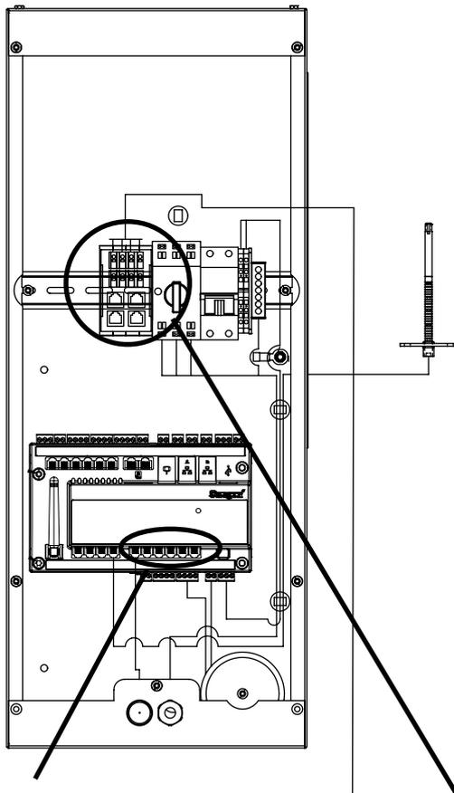
Connecter le câble bus fourni de n'importe quelle borne bus de l'unité de commande vers une borne bus optionnelle de l'adaptateur de câble.
