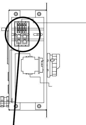
L'adaptateur de câble n'est pas monté. Installez l'adaptateur de câble dans la CTA GOLD sans unité de commande, largement comme sur le schéma de câblage ci-dessus.
