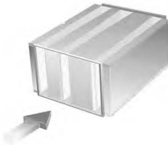
**Figura 5.** Gli splitter del silenziatore CALMO sono stati progettati in accordo con le regole base dell'aerodinamica. In aggiunta, alcuni componenti attivi del silenziatore sono stati posizionati al di fuori della posizione di collegamento. Queste migliorie hanno ridotto considerevolmente la perdita di carico rispetto ai silenziatori comunemente utilizzati.
