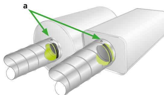
Abb. 1. Aus Brandschutzgründen wird der Anschlusskanal mit Schrauben oder Blindnieten an der hochgezogenen Blechkante befestigt, die im Anschlussstutzen festgossen ist (a).
