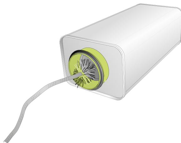
Abb. 2. Reinigung mit Kunststoffbürsten
