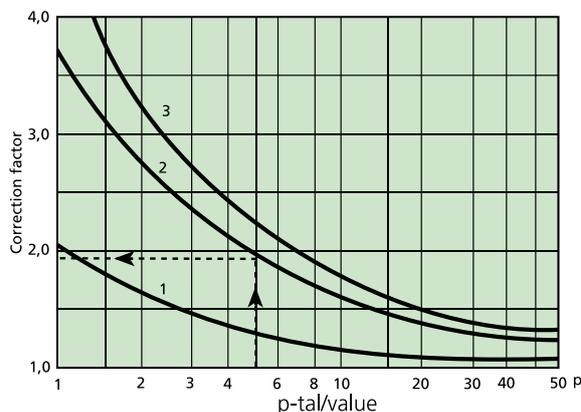
Kurve 1; Kammer-Kanal, Kurve 2; Kanal-Kammer, Kurve 3; Kammer-Kammer
